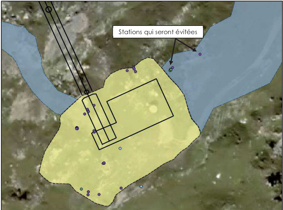
Gare amont de la télécabine avec à droite en bleu la piste Ramy, en jaune le terrassement de la gare
