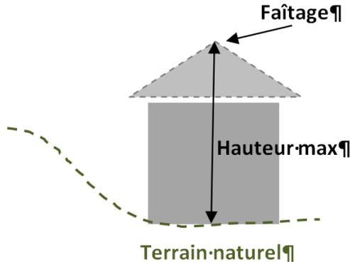
Schéma de principe de calcul de la hauteur – ncu
