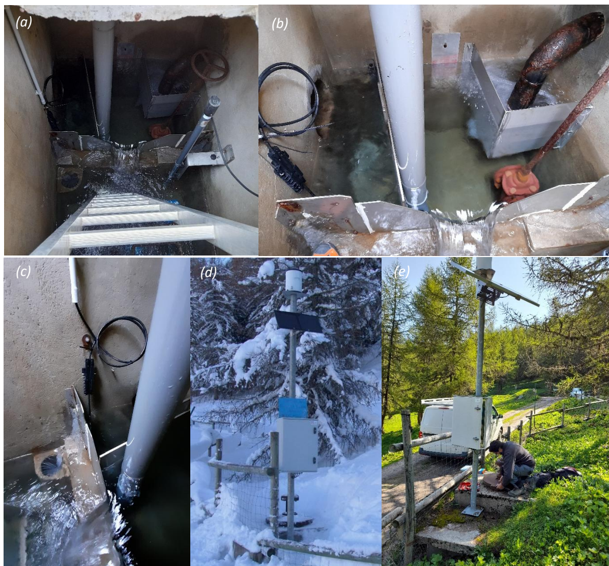
Figure 1 : (a) Vue de l'intérieur du captage depuis l'ouverture du tampon foug ; (b) Bac de l'arrivée de la source, équipé d'un seuil en V (angle 90°) avec à gauche la sonde de niveau et au centre le tube PVC du trop-plein ; (c) Zoom sur la sonde de niveau avec devant une cloison pour limiter les turbulences de l'arrivée ; Vue extérieure du captage (d) en hiver et (e) au printemps.
